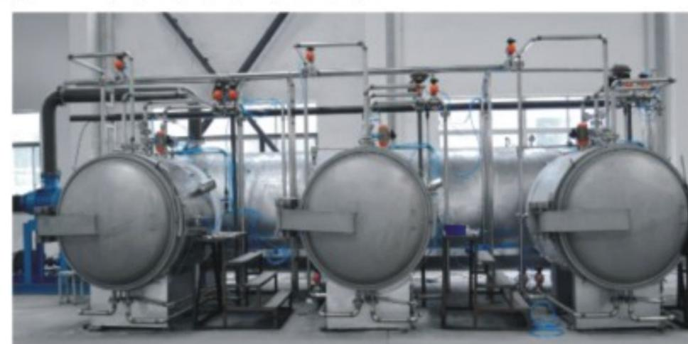
图一、压差膨化设备
